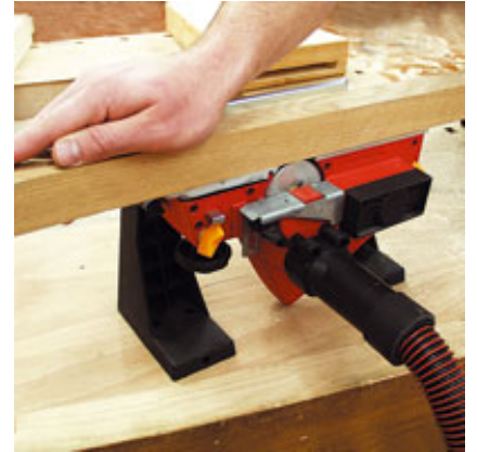
Tous les copeaux sont aspirés facilement.
