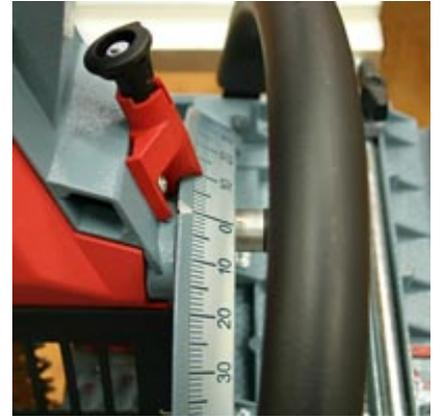
Graduation lisible. Les angles standards de  $-45^{\circ}/0^{\circ}/45^{\circ}$  peuvent être encliquetés facilement.
