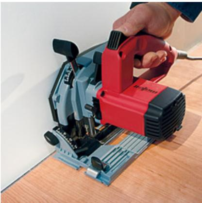
Finition parfaite : Les butées de protection de la scie circulaire portable permettent l'exécution facile d'arasements à partir d'une largeur de 13 mm.
